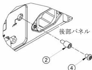
3. マイナス・ドライバを使用して、エクステンダを指締めよりさらに約  $\frac{1}{4}$  回転させるか、校正したマイナス・ドライバ・ビット付きトルク・ツールを使用して、11.5 kg-cm (10 インチ-ポンド) のトルクを掛けます。
