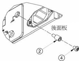
3. 使用一字螺絲起子將延長器再轉緊約  $\frac{1}{4}$ ，或使用一字螺絲起子頭適用的轉矩工具將延長器轉至 10 吋-磅 (11.5 公斤-公分)。
