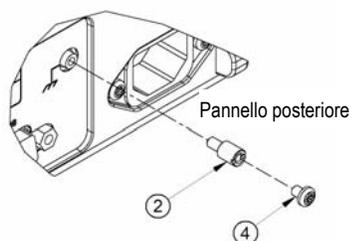
3. Stringere di un altro  $\frac{1}{4}$  di giro con il cacciavite a taglio oppure utilizzare il cacciavite con il controllo della forza di coppia e applicare alla prolunga una coppia di 11,5 kg/cm (10 in-lb).
