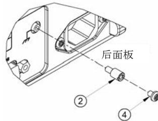
3. 使用十字螺 刀将延器 指状物大 ¼ 圈, 或者使用 十字螺 刀的已校准 矩工具将延器扭 10 in-lb (11.5 千克-厘米)。
