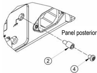
3. Use el destornillador plano para girar el extensor aproximadamente  $\frac{1}{4}$  de vuelta más allá del dedo y ajustarlo bien, o use una herramienta de apriete calibrada con un destornillador de berbiquí plano para apretar el extensor hasta 11,5 kg-cm (10 pulgadas-libras).
