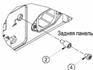
3. С помощью отвертки с плоским лезвием поверните удлинитель еще примерно на  $\frac{1}{4}$  оборота или воспользуйтесь инструментом с откалиброванным усилием затяжки с плоским лезвием и заверните удлинитель с усилием 11,5 кг/см.
