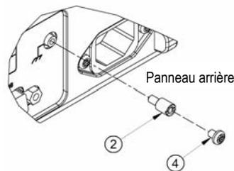
3. Utilisez le tournevis à lame plate pour tourner l'extension d'environ  $\frac{1}{4}$  de tour après le serrage manuel ou un outil de couple étalonné avec un embout de tournevis à la lame plate pour serrer l'extension à 11,5 kilogrammes-centimètres.
