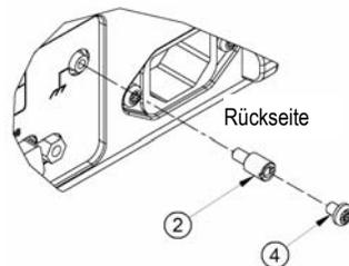
3. Drehen Sie den Extender mit dem Flachschaubenzieher ungefähr eine Vierteldrehung weiter fest, oder verwenden Sie ein kalibriertes Drehmomentgerät mit einem Flachschaubenziehereinsatz, um den Extender auf ein Drehmoment von 11,5 kg\*cm anzuziehen.
